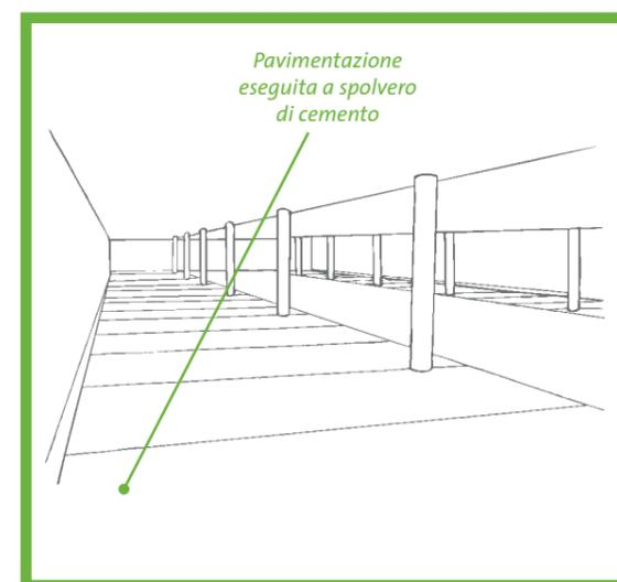
Esempio di applicazione: realizzazione di strutture orizzontali di grandi dimensioni soggette ad usura o a carichi notevoli, che richiedono di prevenire il rischio di fessurazioni.
