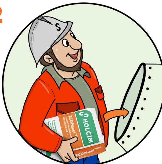
Inserire il sacco di cemento ECOPlanet Prime in una betoniera da almeno 200 litri.
