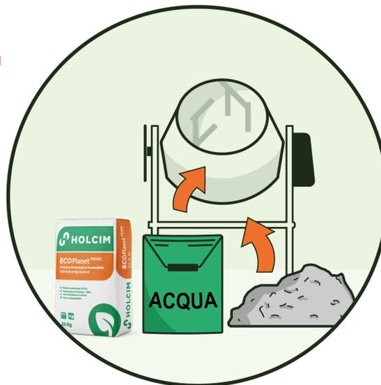
ECOPlanet Prime è ideale per la preparazione di calcestruzzi e malte da muratura. Preparare acqua e aggregati (diametro min. 0/4 mm) a seconda del dosaggio desiderato.
