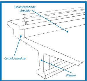
Esempio di strutture orizzontali esterne esposte al gelo ed alla pioggia. È necessario un calcestruzzo che pur inglobando una percentuale di aria, abbia molta compattezza, rapporto a/c basso e maggiori resistenze meccaniche.
