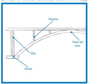
Esempio di strutture verticali esterne esposte a pioggia e gelo e strutture orizzontali protette non soggette a completa saturazione che necessitano calcestruzzi compatti con rapporti a/c bassi e con elevate resistenze meccaniche.
